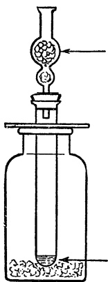
Рис. 7. Опыт взаимодействия брома с алюминием с использованием поглопителя.
