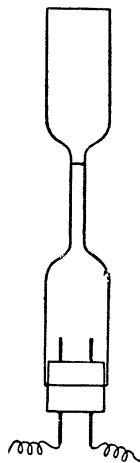
Рис. 629. Прибор для демонстрации уменьшения объема воды при электролизе.
