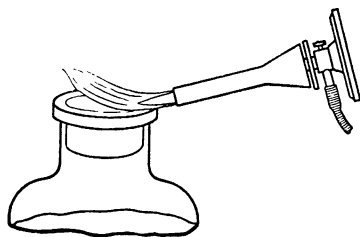
Рис. 256. Прогревание краев банки горелкой.
