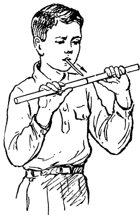
Рис. 186. Разламывание толстой стеклянной трубки с дутьем.
