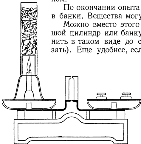
Рис. 506. Горение свечи на весах с поглощением продуктов горения.
