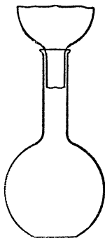
Рис. 441. Воронка из обрезанной колбы.
